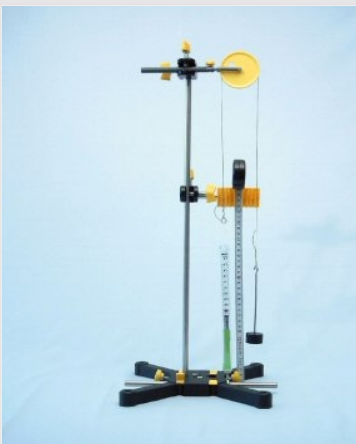
Montaje para determinar la fuerza en un rodillo fijo
